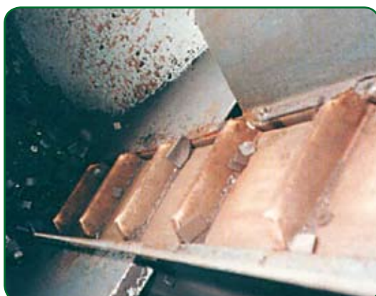
FRG-3 z zabierakami o grubości 8 mm - Transportowanie magnetytu
